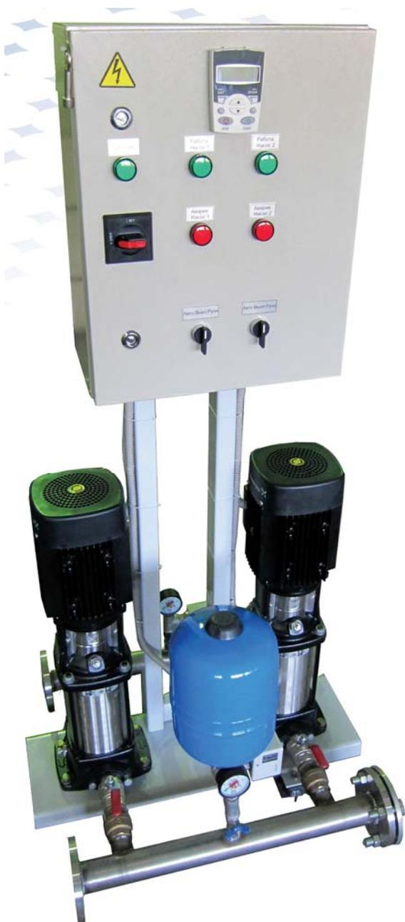
Установки повышения давления класса «Стандарт»: KV Hydro.VS являются компактными автоматическими насосными станциями, поддерживающими неизменным заданное выходное давление, независимо от изменяющегося расхода, путем регулирования числа оборотов двигателя основного насоса и подключением/отключением дополнительных насосов. Установки поставляются собранными, испытанными, готовыми к подключению и вводу в эксплуатацию.
